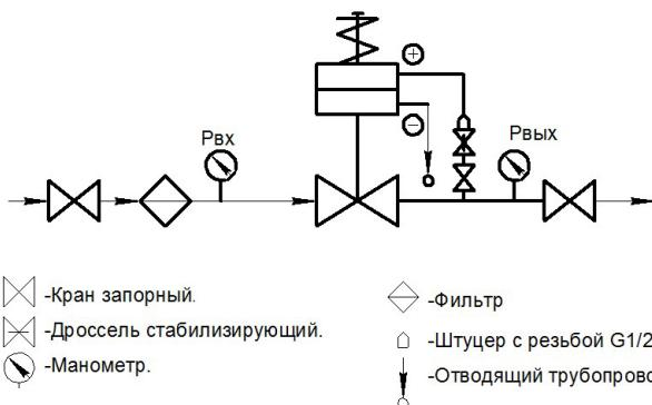
Схема подключения регулятора давления "после себя" РА-А с конденсационно-разделительным сосудом
