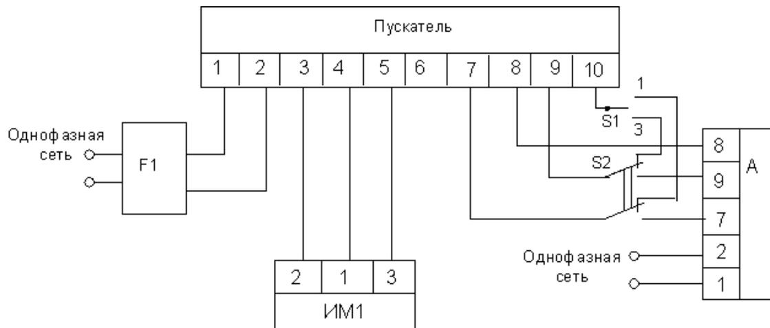
Рисунок В.1 – Схема внешних соединений пускателя ПБР-2М1
