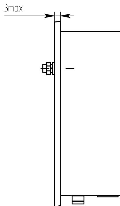
Рисунок Б.2 – Крепление со стороны боковой стенки кожуха
