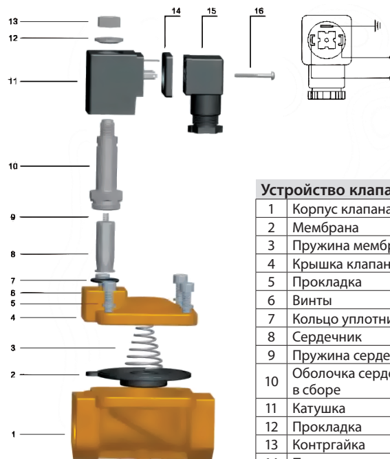
Устройство клапана KSP
