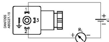
Кабельный ввод необходимо с усилием закрутить для обеспечения герметичности.
