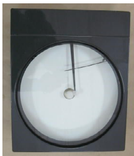
Рисунок 1 - Общий вид манометров дифференциальных сильфонных самопишущих и показывающих ДСС и ДСП с местом пломбировки Знак поверки наносится в паспорт и (или) на свидетельство о поверке.
