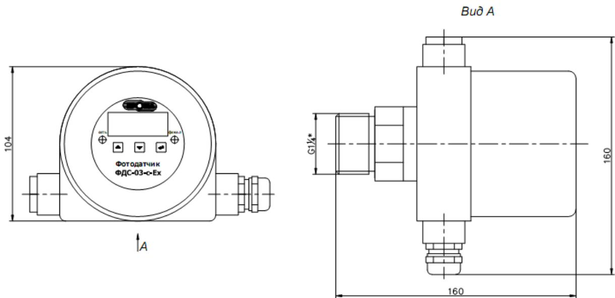
Рис.3 Конструкция фотодатчика ФДС-03-с-Ех.
