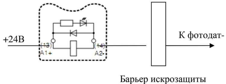
Подключение внешних цепей вести многожильными медными проводами сечением (0,35-0,5) мм<sup>2</sup>.
