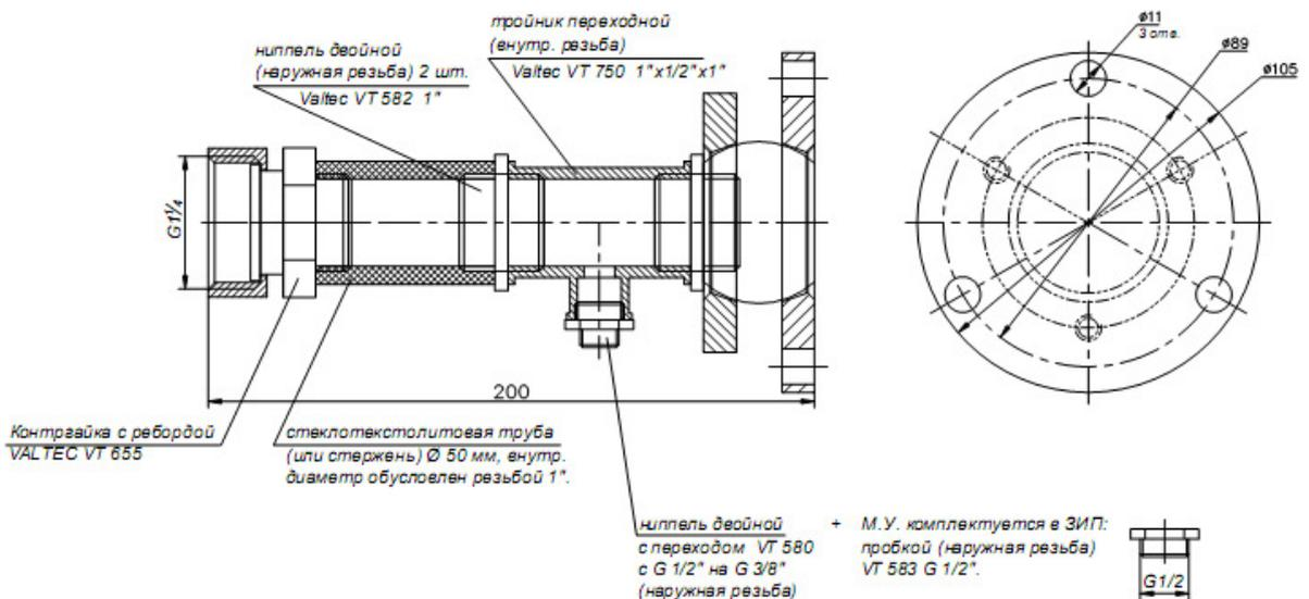
Рис.5б. Фланец монтажный юстировочный для ФДС-03-с-Ех.
