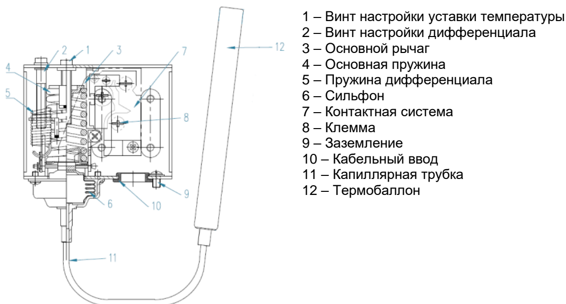
Рис.1. Устройство реле температуры
